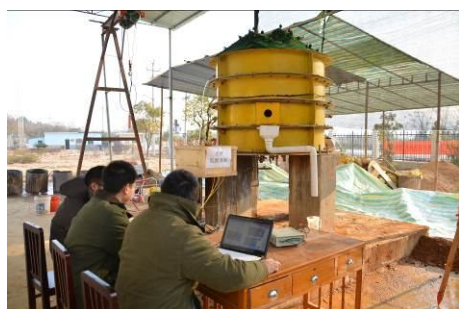
图 6 注浆三维模型试验系统
